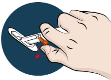
**Рисунок 17.** Снимите стопорный штифт
